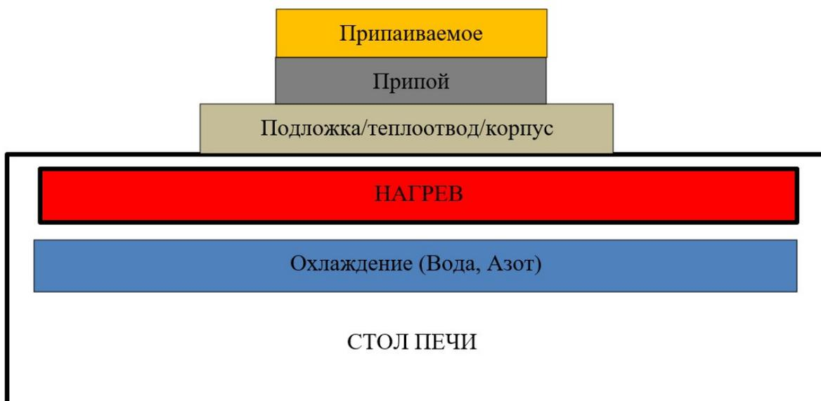
Рисунок 9. Вакуумная камера печи пайки серии RC с кондуктивным нагревом.
