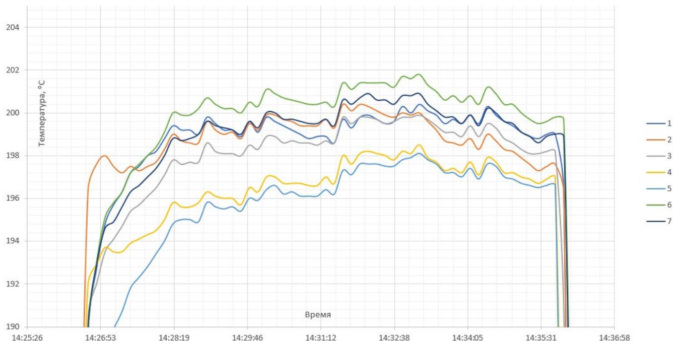
Рисунок 14. Распределение температуры по зоне равномерности 160x160 мм.
